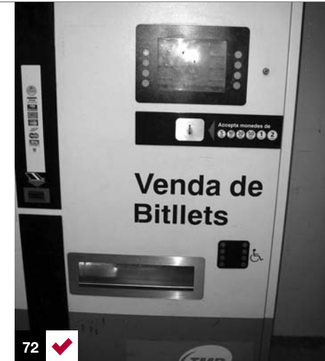
Foto 72: expendedora de tickets de uso universal, con alturas adecuadas para el uso de las personas tanto de pie como sentadas. Barcelona, España.
