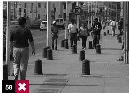
Foto 58: desorden en la ubicación de pilotes. Son obstáculos peligrosos para personas ciegas. Antofagasta, Chile.
